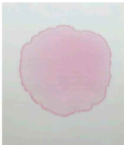
►23 und ►24 Ein Tropfen Testflüssigkeit auf einer unbehandelten PEEK-Oberfläche (►23) und auf der Oberfläche der identischen Probe, die 20 Minuten im Niederdruck-Plasma-Rezipienten aktiviert wurde. Benetzung pur!
