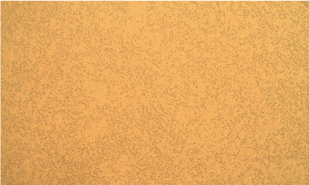
▣ 29 So sieht die perfekte Oberfläche eines Blanks aus hochgoldhaltiger Legierung aus. Mit der Gusstechnik im Labor kaum erzielbar.
