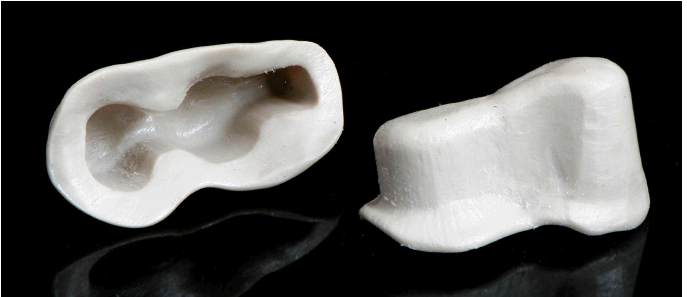
► 10 Auch diese Matrizen aus PEEK für jeweils einen Mini-Steg sind innen zu rau gefräst. (Bild: dentalgerade, M. Wepler)
