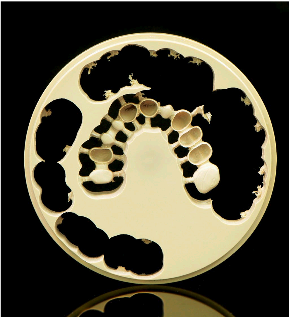
► 11 Negativbeispiel von Teleskop-Innenflächen aus PEEK. Hier wurde lediglich mit einer 3-Achs- Maschine und unzureichendem Finish gefräst.
